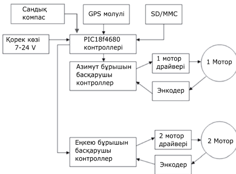
Сурет 1.28 – Бағдарлау сенсорына негізделген күнді бақылау жүйесінің блок сұлбасы [49]
