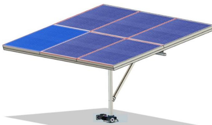
Сурет 2.25 – Autodesk Inventor бағдарламасында жасалған 6 күн батареясынан тұратын трекердің моделі [102, 293 б.]
